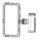
(2) 快拆拓展: 在拓展框四边框体上分别有1个快拆卡槽,卡槽与框体上的1/4"-20螺纹孔相互配合,可拓展SmallRig独有的快拆生态系统。
