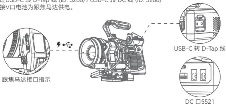
4.2 通过标配的USB-C转USB-C线连接跟焦手柄与跟焦马达供电，同时实现有线控制。
