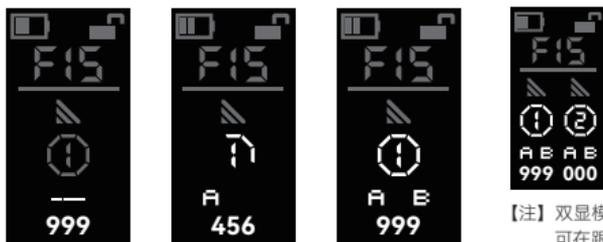
电控模块：同时单击 **▲/▼** 键，单击 REC “**REC**” 键打A、B点，同时单击 **▲/▼** 键取消打点。
