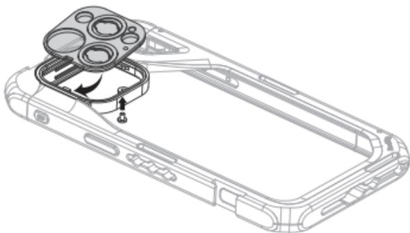
(5) **安装滤镜**: 在拓展框镜头背板上安装滤镜转接环, 即可使用外接滤镜。滤镜和M-卡口滤镜转接环需单独选购。
