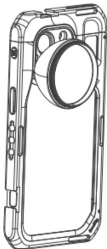
**替换镜头背板：**用螺丝刀拆卸下拓展框内部的1/4"-20螺丝，向右斜上方取出镜头背板。如下图所示，将需要替换的镜头背板向左斜下方卡入拓展框背部卡槽，然后将镜头背板嵌入拓展框主体，最后从框体内部锁紧1/4"-20螺丝。
