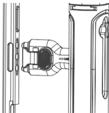
(3) **装载手机**：按压图一中 ①解锁按钮，打开拓展框上盖，将手机缓慢滑入拓展框主体。随后合上并按压拓展框上盖直至听见“咔哒”声，表明拓展框上下盖已锁止。
