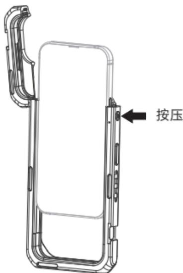
(4) **安装外接镜头：**通过拓展框背部的镜头背板，可在手机拍摄时拓展外接镜头。连接不同规格的外接镜头可通过替换镜头背板，或增加转接件实现。目前SmallRig iPhone 15系列的拓展框支持外接M-卡口镜头、17mm直径螺纹镜头、37mm直径螺纹镜头和M品牌的T系列镜头。拓展框标配M-卡口镜头背板，17mm、37mm和T系列镜头背板需单独选购。
